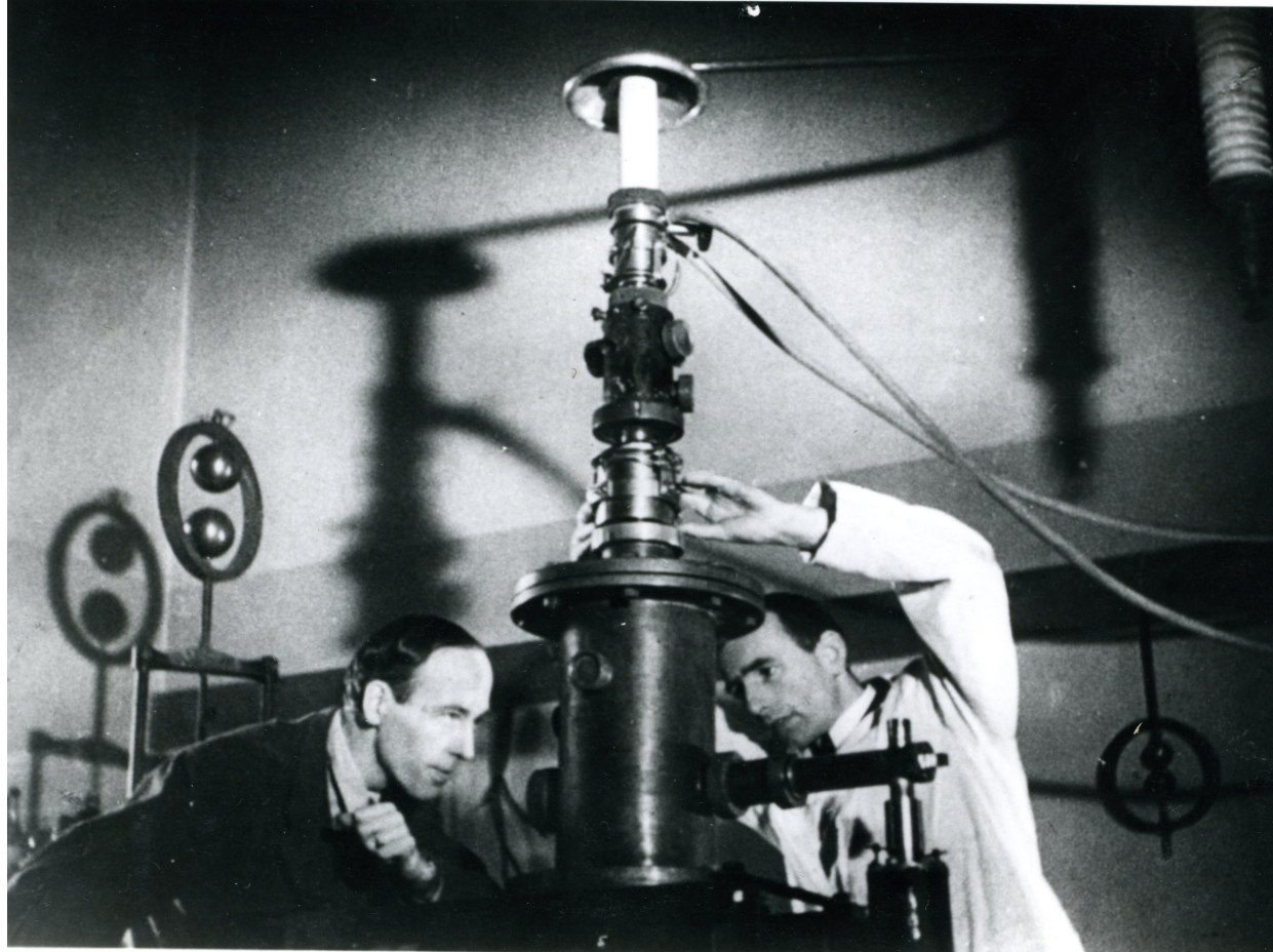
M. Knoll und E. Ruska am ersten Elektronenmikroskop M. Knoll, E. Ruska: Beitrag zur geometrischen Elektronenoptik I u. II, Ann. Physik 12 (1932) 607-640, 641-661 (eingegangen 10.9.1931) © Plant Development
